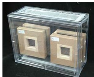
Photo 3 : boîte de 4 éprouvettes expérimentales identiques de tableaux rentoilés, utilisée pour les tests d'infestation. (Cliché Odile Guillon-CICRP)
