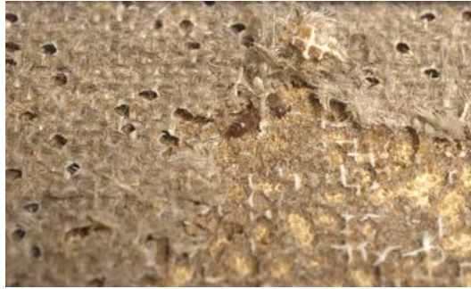
Photo 1 : dégradation du revers d'une peinture ré entoillée à la colle de pâte faisant apparaître les trous d'envol et un manque important de matière. (Cliché Emilie Hubert-CICRP)
