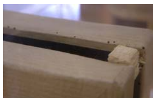
Photo 4 : éprouvette avec trous d'envol observés entre la toile et le châssis (Cliché Fabien Fohrer-CICRP)
