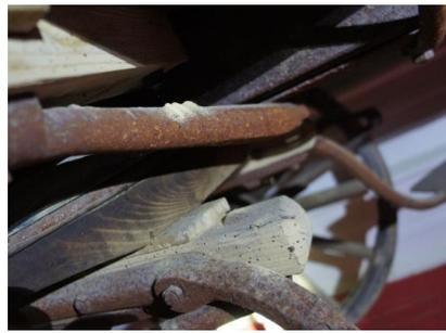
*Traces d'infestation à Vers Pont-du-Gard : vermoultures de petite vrillette et trous d'envol*
