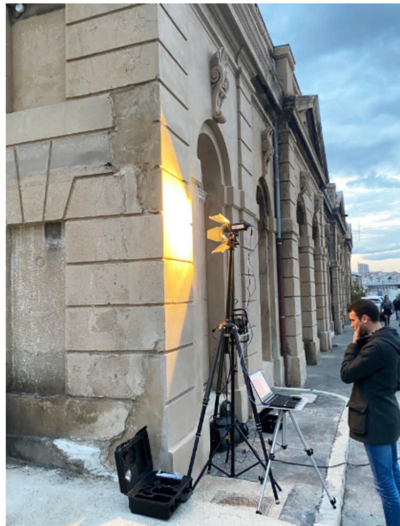
Bâtiment des Douanes, Marseille : essai de thermographie infrarouge pour évaluer les remplissages après coulinage. Photo : CICRP - P. Bromblet.
