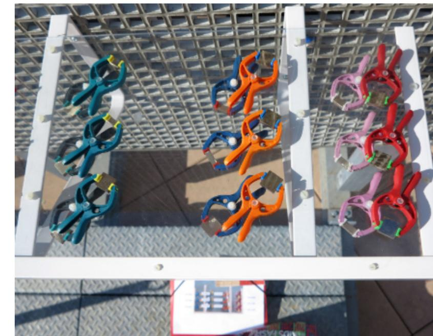
Exposition d'échantillons de bronzes de cloches en conditions exposées ou abritées sur la plateforme de vieillissement naturel du CICRP située sur le toit des réserves du Mucem. Programme Bellacorr.
