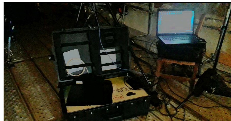
Utilisation du système expérimental « Thermo-Art » lors de l'étude des peintures murales de l'église de Montgauch par thermographie IR en mode stimulé.
