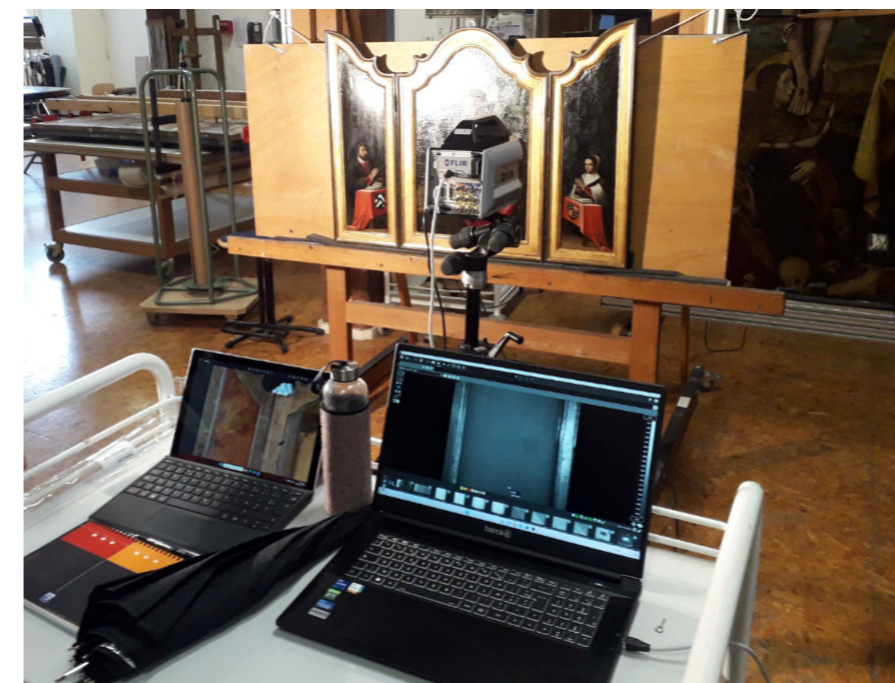
Essai d'utilisation en mode stimulé, de la caméra thermique haute fréquence acquise dans le cadre du projet ESPADON (Triptyque de la Vierge à l'Enfant et au perroquet, Atelier du Maître au perroquet, XVI e s.). Photo : CICRP - J.-M. Vallet.
