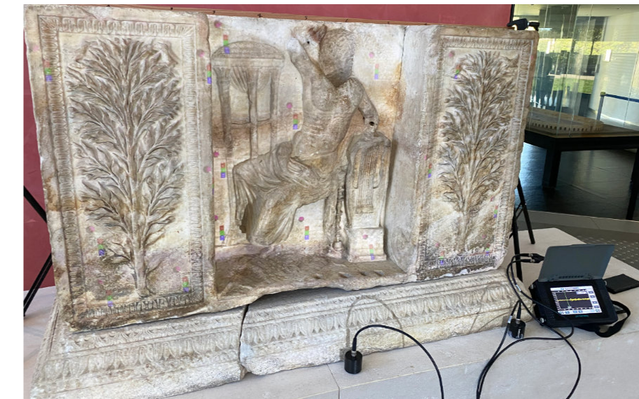
Musée départemental Arles antique, Arles : essai de mesure acoustique couplée à l'imagerie 3D sur un autel à Apollon provenant du théâtre antique. Photo : CICRP - P. Bromblet.
