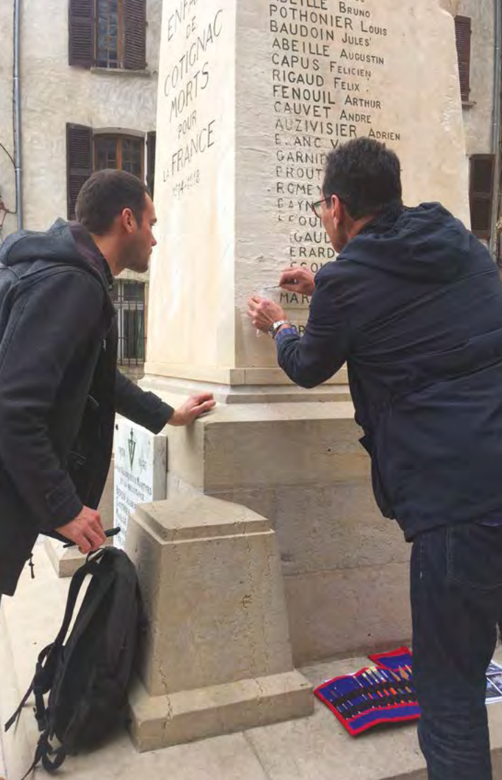
Monument aux morts, Cotignac : prélèvement de cristallisations salines par Philippe Bromblet et Jérémie Berthonneau.
