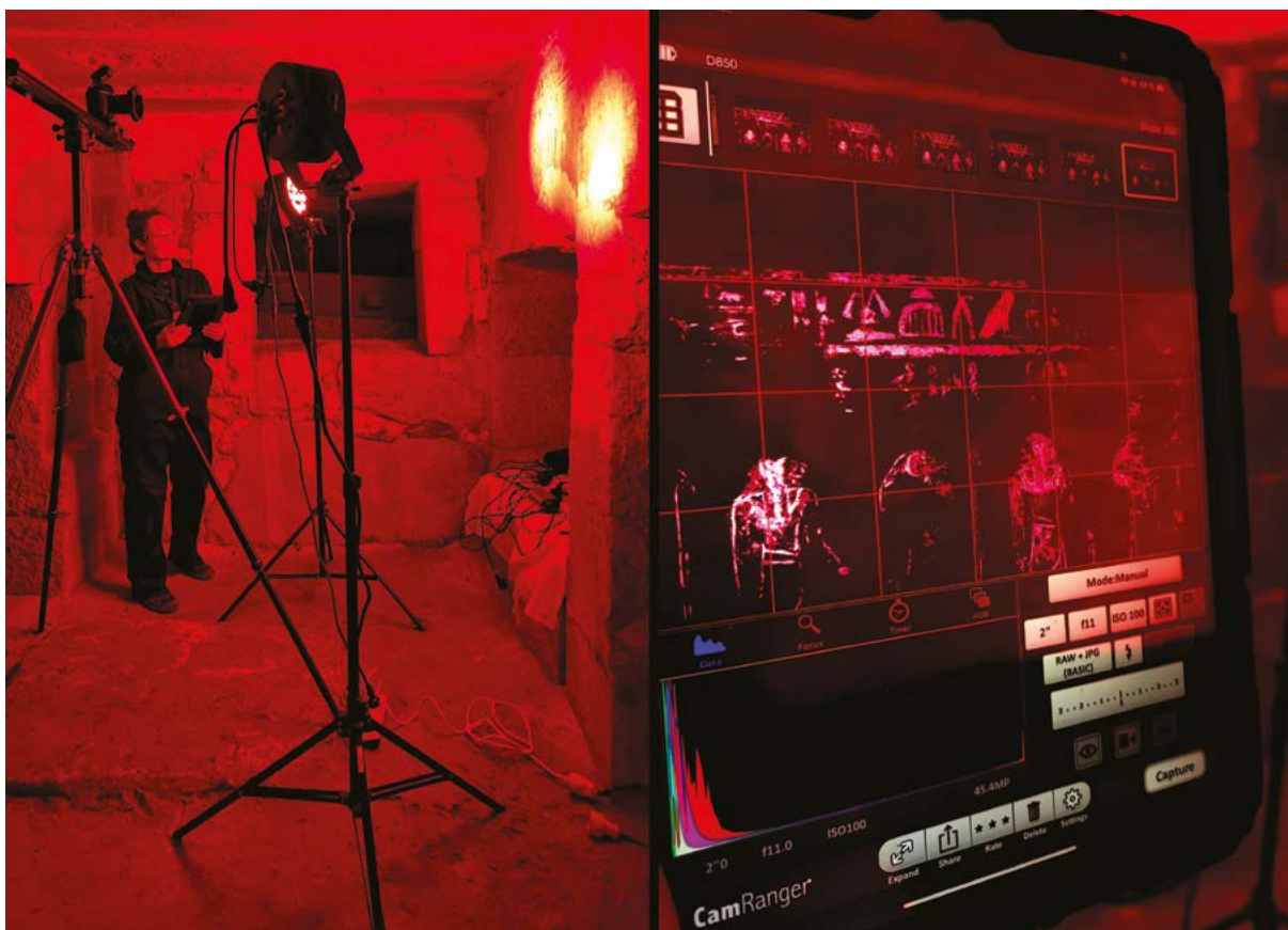
Antichambre de la tombe de Psousennès 1 er , Tanis, Egypte : prise de vue par Emilie Hubert-Joly des fluorescences du pigment bleu égyptien dans le proche IR, sous LEDS émettant à 610 nm avec observation directe sur écran.
