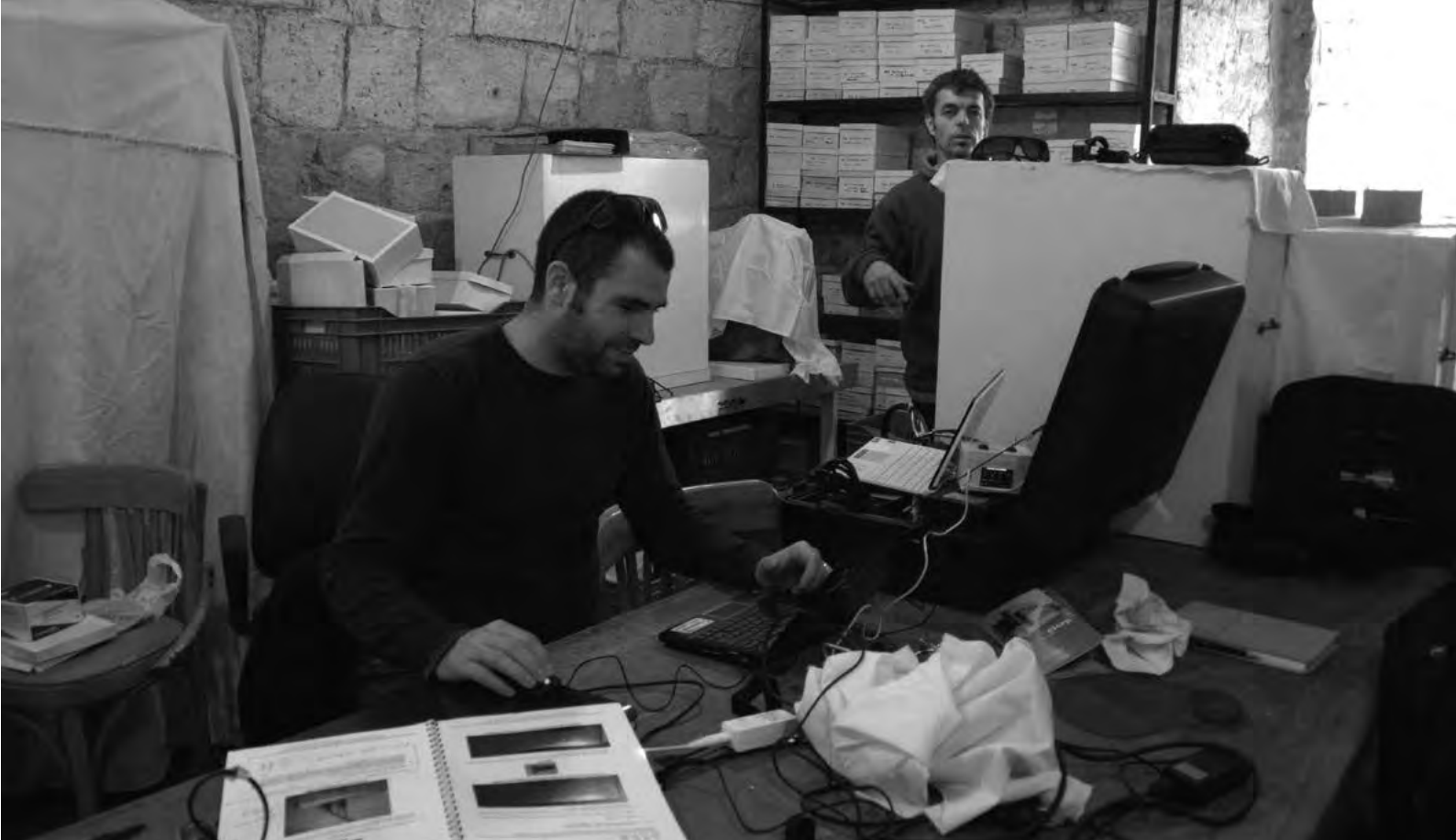
Analyse d'échantillons stockés dans les réserves et ateliers du Centre d'études alexandrines (Égypte) par micro-fluorescence X et par LIBS, par Nicolas Bouillon et Jean-Marc Vallet.
