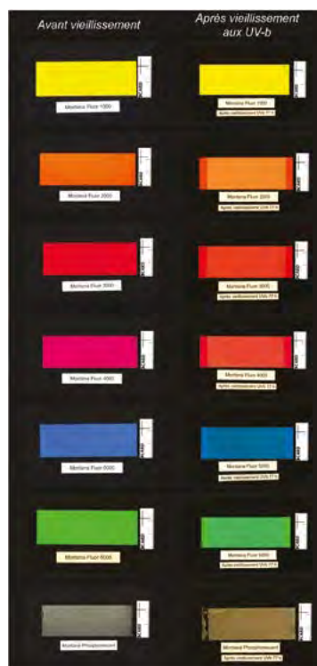
Echantillons de spray avant et après vieillissement en enceinte UV-b durant 77 heures
