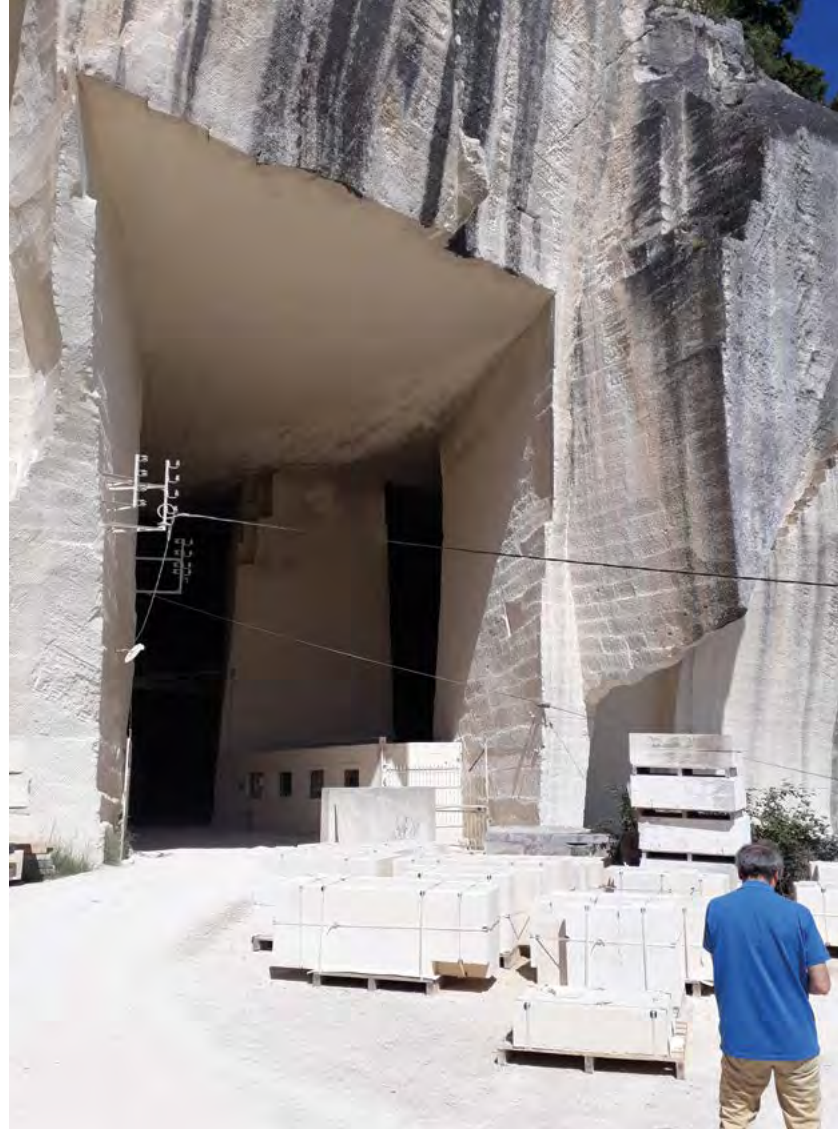
Entrée d'une des carrières souterraines d'extraction de la pierres des Estailades (molasse burdigalienne) : approvisionnement en éprouvettes de pierre pour des expérimentations en laboratoire.
