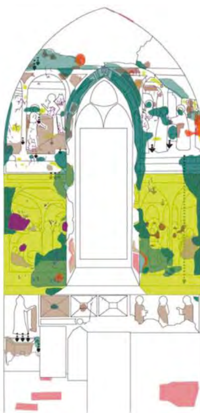
Matteo Giovannetti, chapelle des fresques, 1355, chartreuse de Villeneuve-lès-Avignon : calque descriptif des altérations sur la paroi est sur image photogrammétrique.
