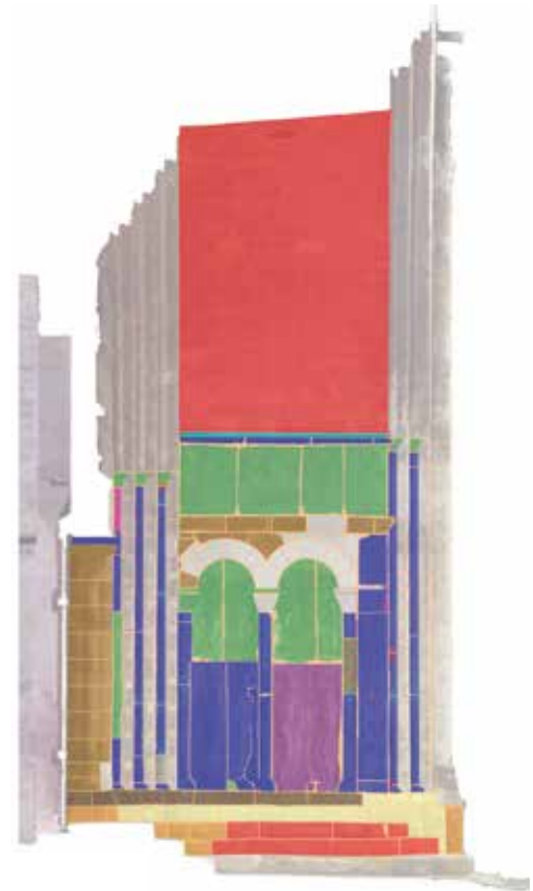
(fig. 2) Côté droit ou est, nature des pierres et des mortiers.
