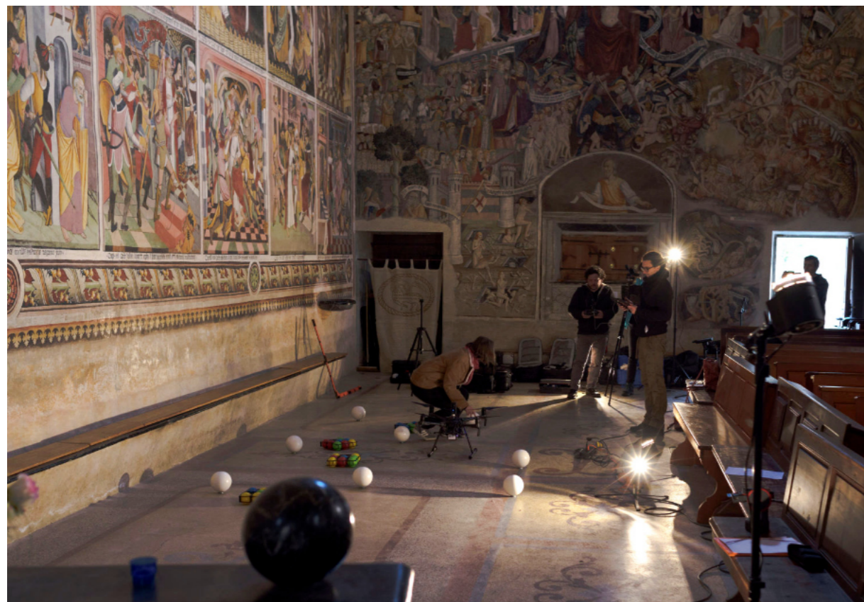
Chapelle Notre-Dame-des-Fontaines, La Brigue : essais d'acquisition photogrammétrique simultanée d'images en visible et IR.
