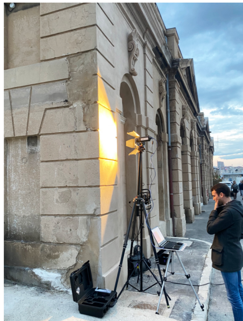
Bâtiment des Douanes, Marseille : essai de thermographie infrarouge pour évaluer les remplissages après coulage. Photo : CICRP - P. Bromblet.
