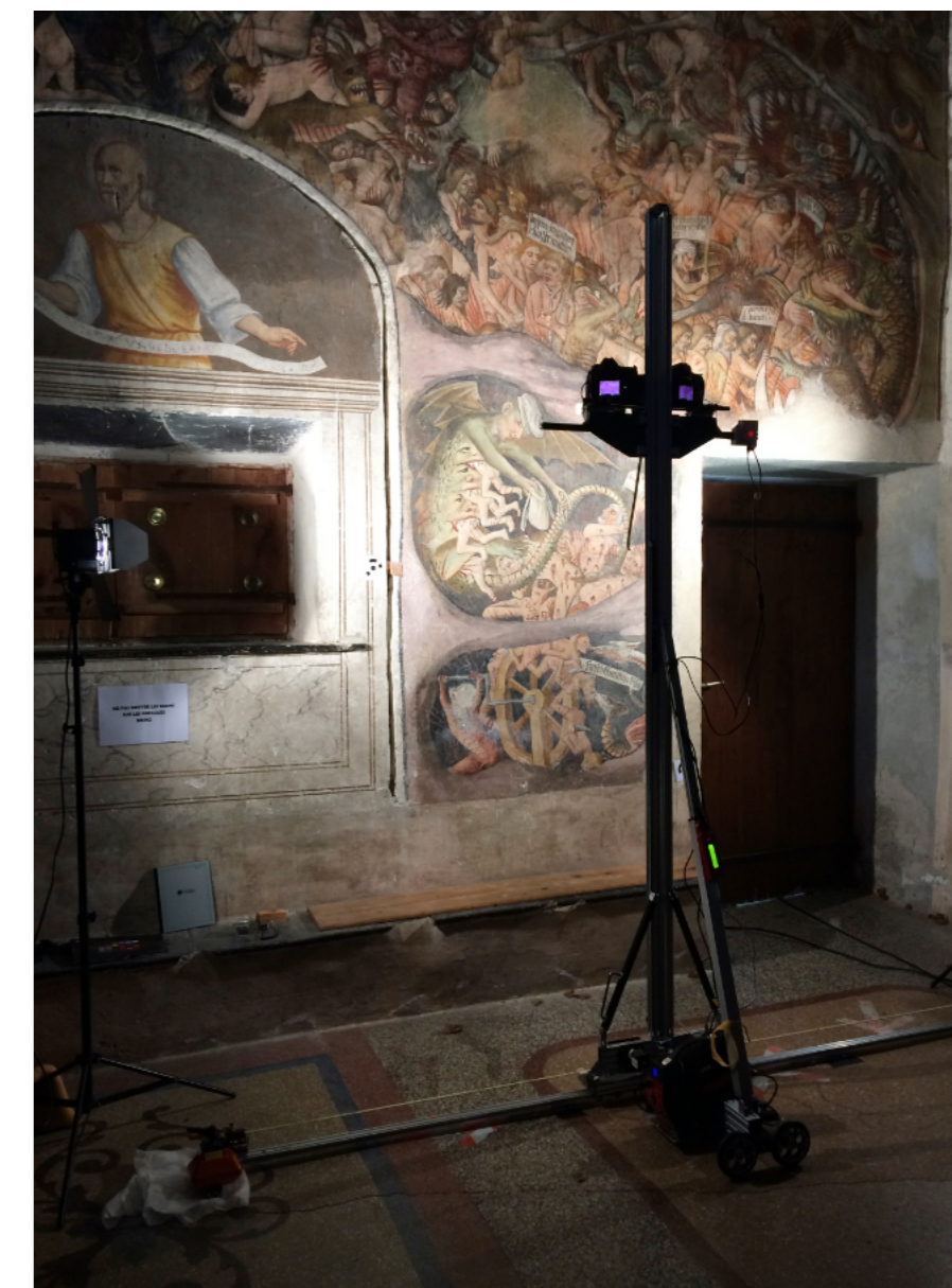
Chapelle Notre-Dame-des-Fontaines, La Brigue : acquisition photogrammétrique. Photo : CICRP - O. Guillon.
