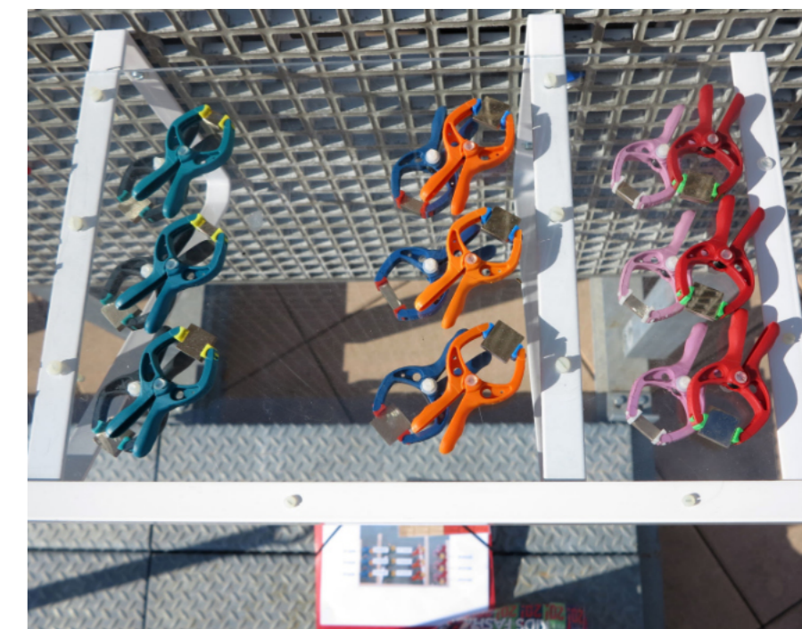
Exposition d'échantillons de bronzes de cloches en conditions exposées ou abritées sur la plateforme de vieillissement naturel du CICRP située sur le toit des réserves du Mucem. Programme Bellacorr. Photo : CICRP - J.-M. Vallet.
