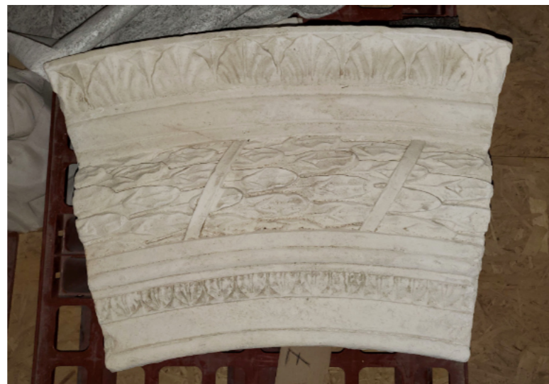
Le claveau A7 de la chapelle a été retenu pour l'étude des gains de cohésion obtenus par injection par étapes de phosphate de diammonium (DAP) et de Plextol® B500, le nouveau protocole proposé par B. Lafay
