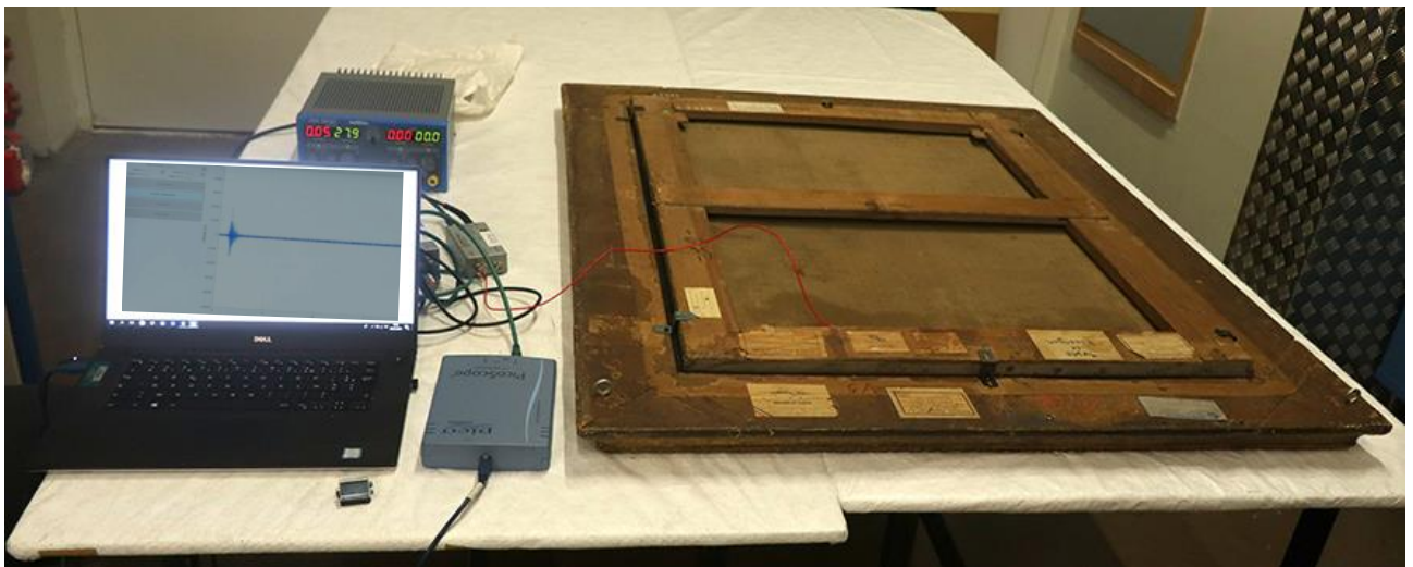
Système ATAX complet dont le capteur est placé au revers d'un châssis d'une peinture de chevalet
